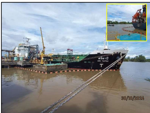
ภาพถ่ายที่ 2.2-5 การควบคุมการรั่วไหลของน้ำมัน ระหว่างการขนถ่าย
