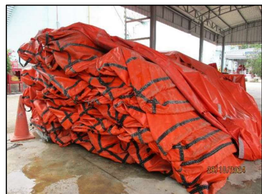
ภาพถ่ายที่ 2.2-8 ตัวอย่างอุปกรณ์กำจัดคราบน้ำมัน
